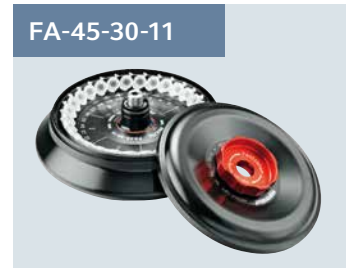
Rotor 30 x 1,5/2 mL mit aerosol- dichtem QuickLock-Deckel zum sicheren Zentrifugieren von ge- fährlichen Proben in Reaktions- gefäßen. Max. Geschwindigkeit 20.800 \times g (14.000 rpm).
