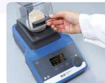
Schritt 5 | Mahlbecher abnehmen
