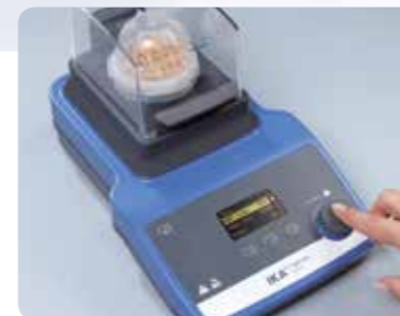
Schritt 3 | Mahlvorgang starten
