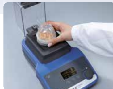
Schritt 2 | Mahlbecher auf Tube Mill aufsetzen
